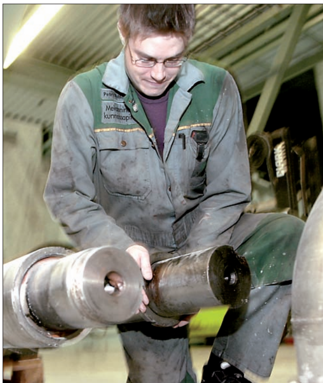
Investoinnissa tehtaan kahta hiertämöä käsiteltiin yhtenä kokonaisuutena. Kuvassa Petri Valtonen mekaanisesta kunnossapidosta valmistelee hakekairan remonttia PK 6:n hiertämöllä.
